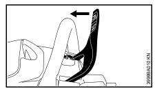
Tire del protector de la mano hacia el mango delantero hasta que se escuche que traba y el protector de la mano se encuentre en la posición ① – se suelta el freno de la cadena Instalación de la cadena de aserrado
